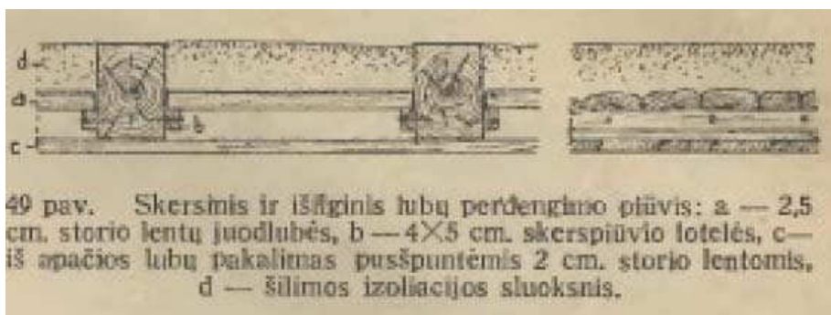
03 pav. Perdangos detalė būdinga statinio statybos laikmečiui (1933m)
